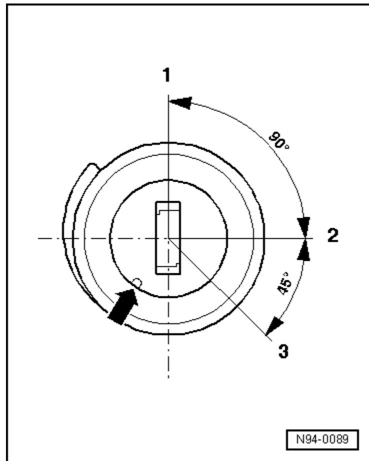
为了更好的显示, 以下示图显示了已拆卸的无点火钥匙的锁芯。
