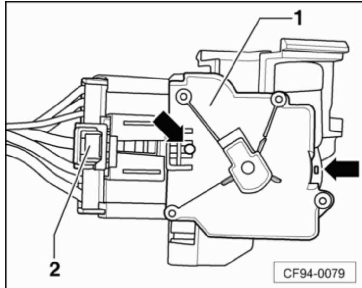
下部件的孔 -箭头 **B**- 与点火开关的旋转杆 -箭头 **A**- 相对应。
